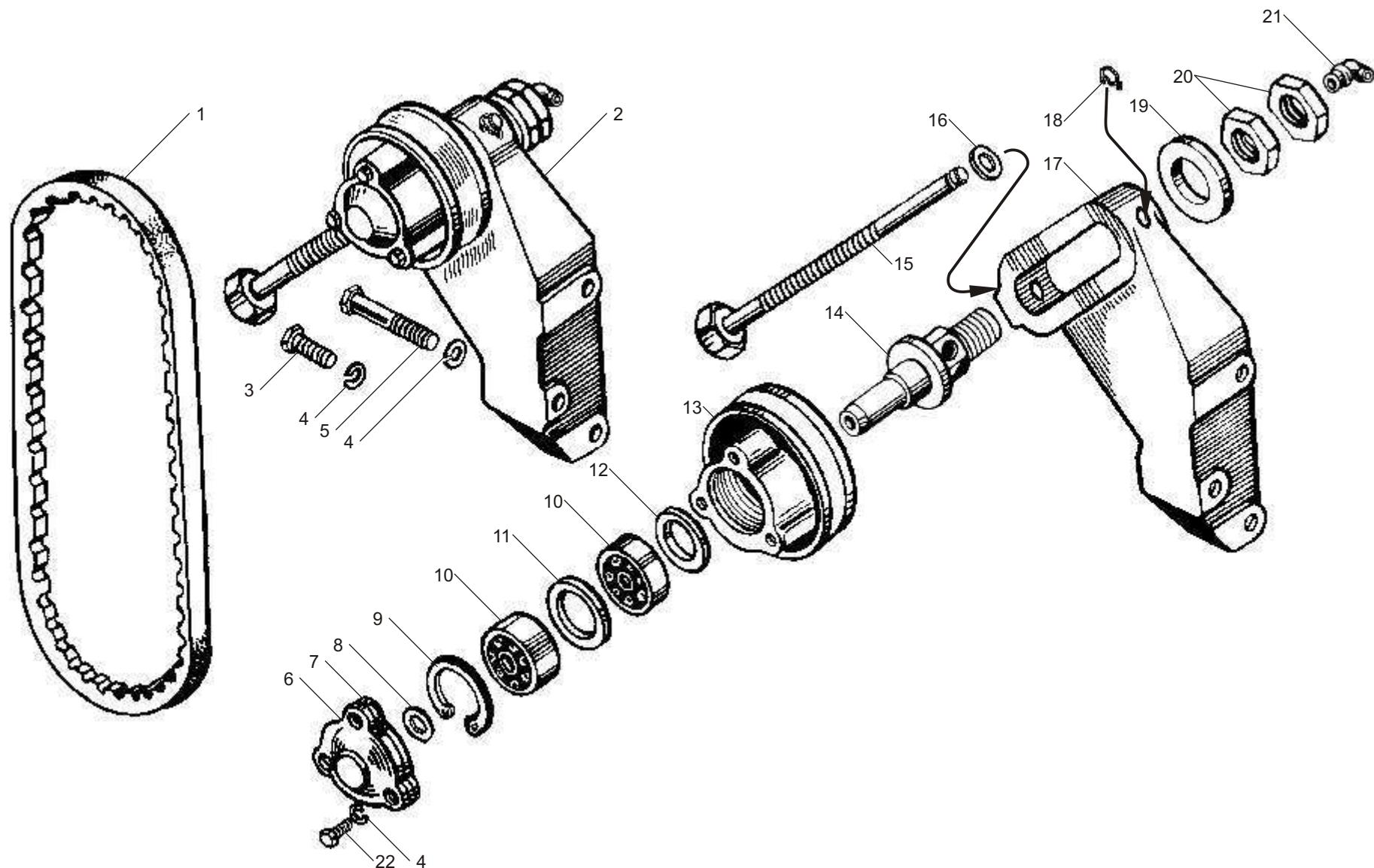
Рис. 33 УСТРОЙСТВО НАТЯЖНОЕ КОМПРЕССОРА двигателей ЯМЗ-6562.10, ЯМЗ-6563.10
