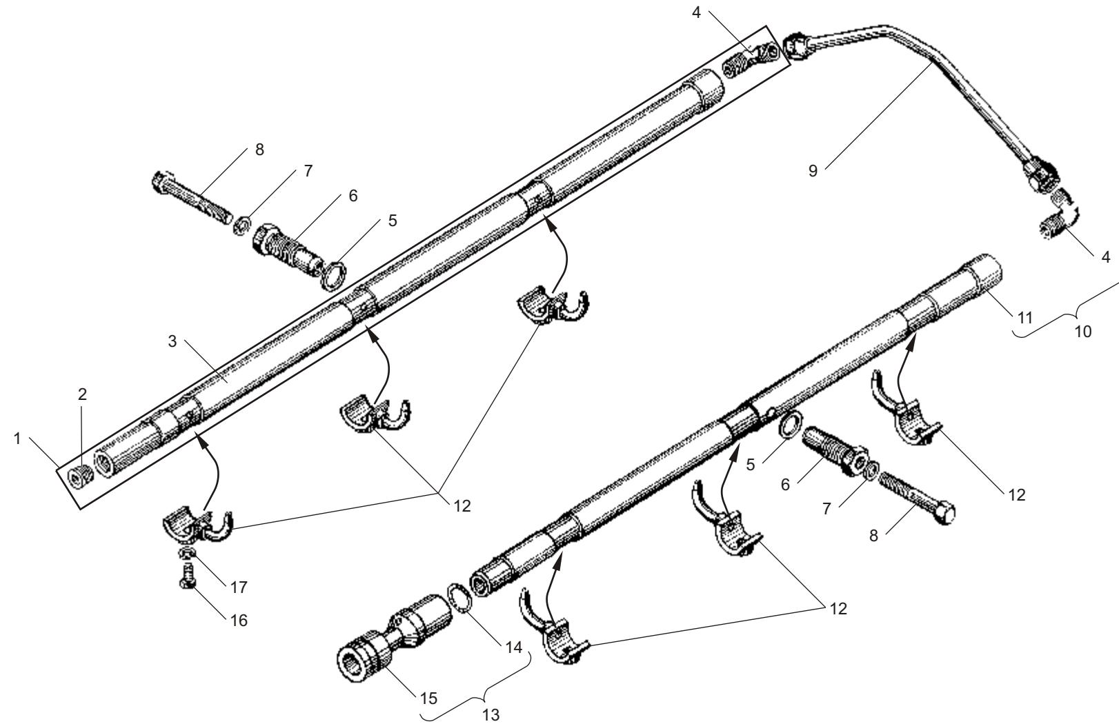
Рис. 12 СИСТЕМА ОХЛАЖДЕНИЯ ПОРШНЕЙ МАСЛОМ двигателей ЯМЗ-6562.10, ЯМЗ-6563.10
