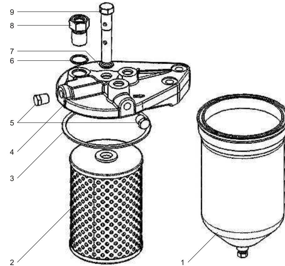
Рис. 26 ФИЛЬТР ТОНКОЙ ОЧИСТКИ ТОПЛИВА двигателей ЯМЗ-6562.10, ЯМЗ-6563.10
