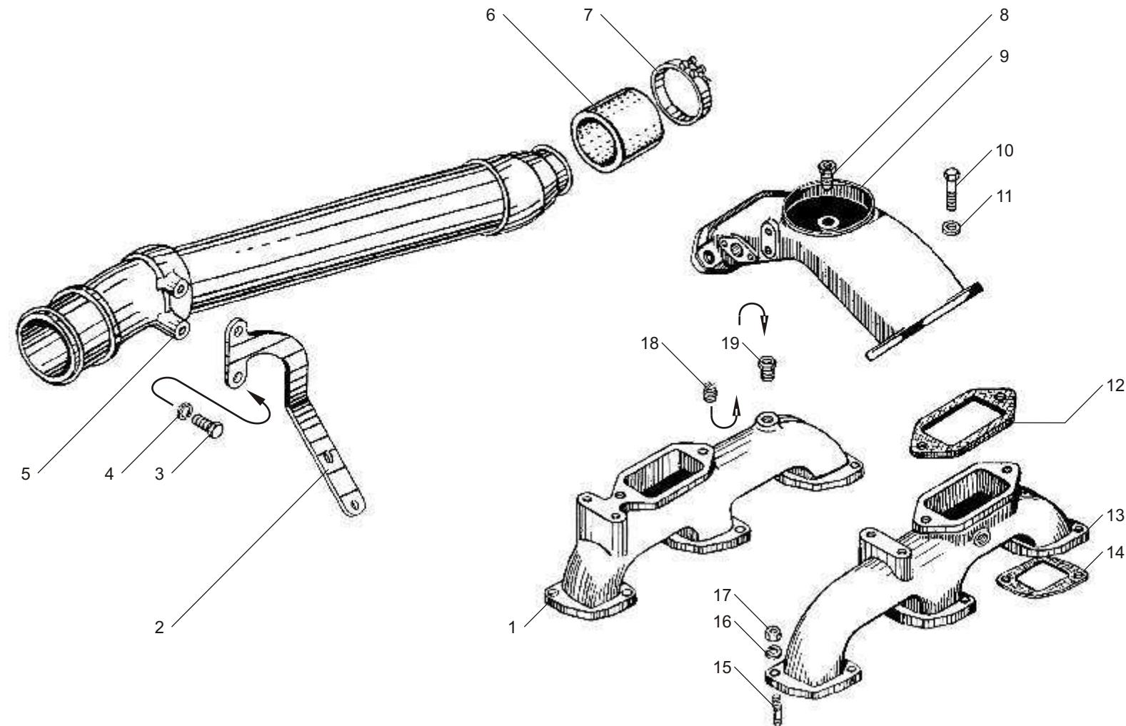
Рис. 25 КОЛЛЕКТОРЫ ВПУСКНЫЕ двигателей ЯМЗ-6562.10, ЯМЗ-6563.10
