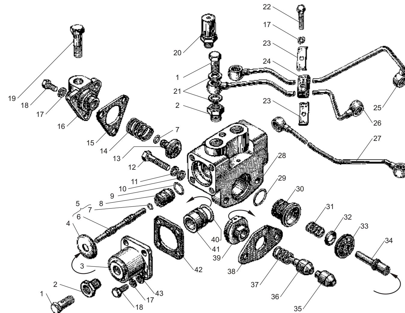
Рис. 11 УПРАВЛЕНИЕ МЕХАНИЗМОМ ПЕРЕКЛЮЧЕНИЯ ДЕМУЛЬТИПЛИКАТОРА КП ЯМЗ-2381 для двигателя ЯМЗ-6562.10
