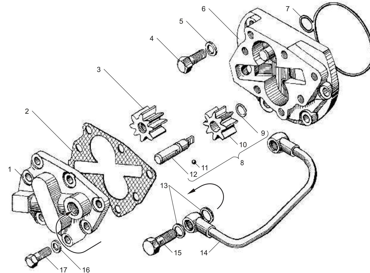
Рис. 12 МАСЛЯНЫЙ НАСОС КП ЯМЗ-2381, ЯМЗ-2361 для двигателей ЯМЗ-6562.10, ЯМЗ-6563.10
