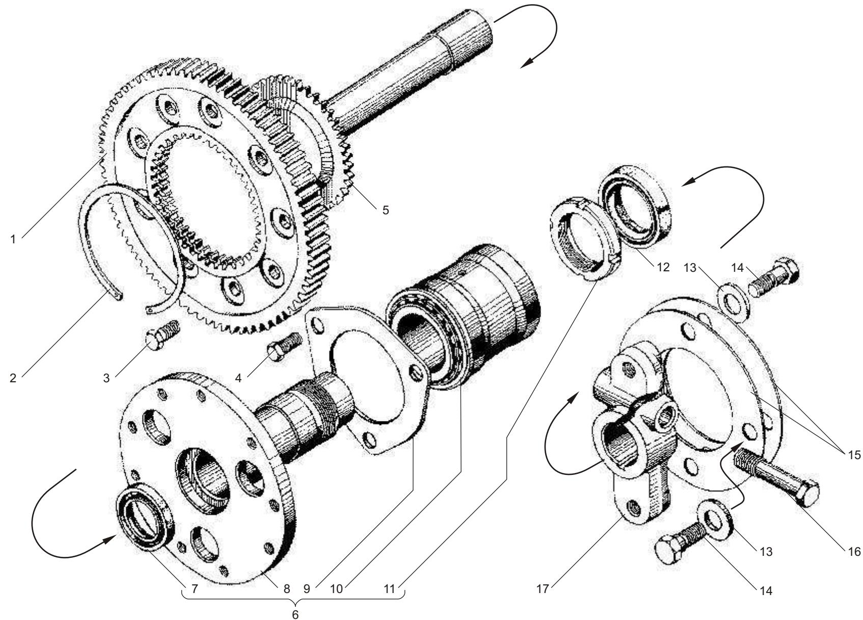
Рис. 18 ПРИВОД ТНВД двигателей ЯМЗ-6562.10, ЯМЗ-6563.10
