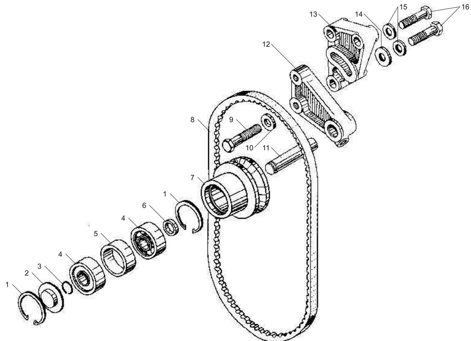
Рис. 30 УСТРОЙСТВО НАТЯЖНОЕ РЕМНЯ ПРИВОДА ВОДЯНОГО НАСОСА двигателей ЯМЗ-6562.10, ЯМЗ-6563.10
