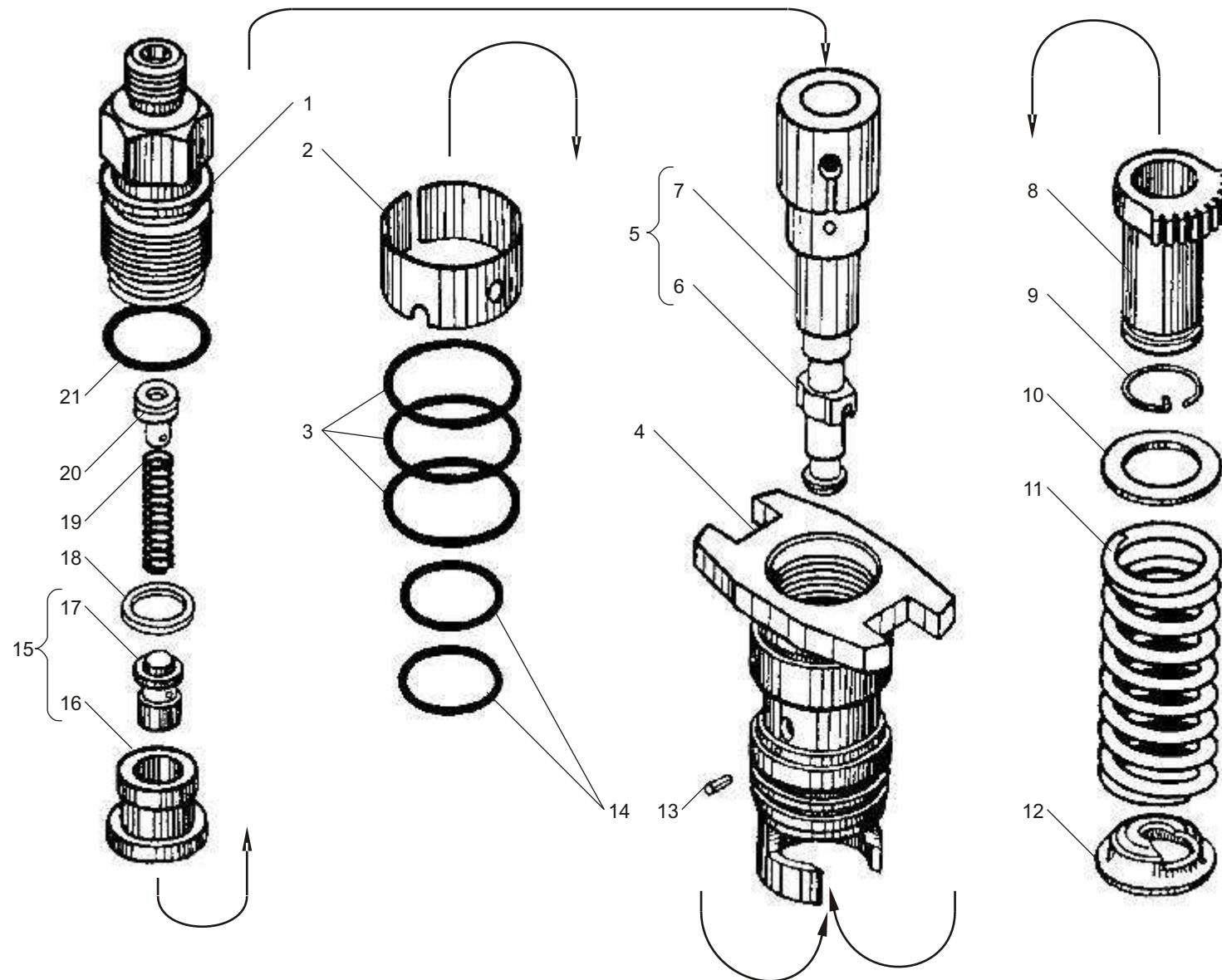
**Рис. 23 СЕКЦИЯ ТОПЛИВНОГО НАСОСА ВЫСОКОГО ДАВЛЕНИЯ двигателей ЯМЗ-6562.10, ЯМЗ-6563.10**
