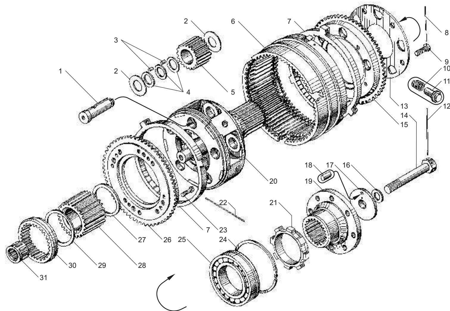
Рис. 10 ВАЛЫ И ШЕСТЕРНИ ДЕМУЛЬТИПЛИКАТОРА КП ЯМЗ-2381 для двигателя ЯМЗ-6562.10
