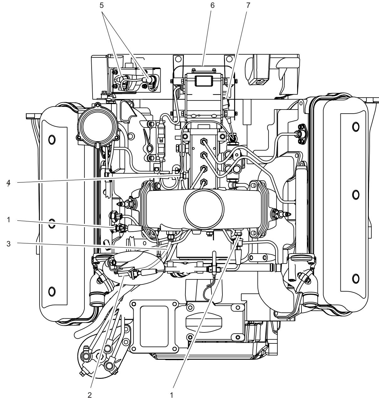
Рис. 37 УСТАНОВКА ДАТЧИКОВ ЭЛЕКТРОННОЙ СИСТЕМЫ УПРАВЛЕНИЯ (ЭСУ) двигателей ЯМЗ-6562.10, ЯМЗ-6563.10
