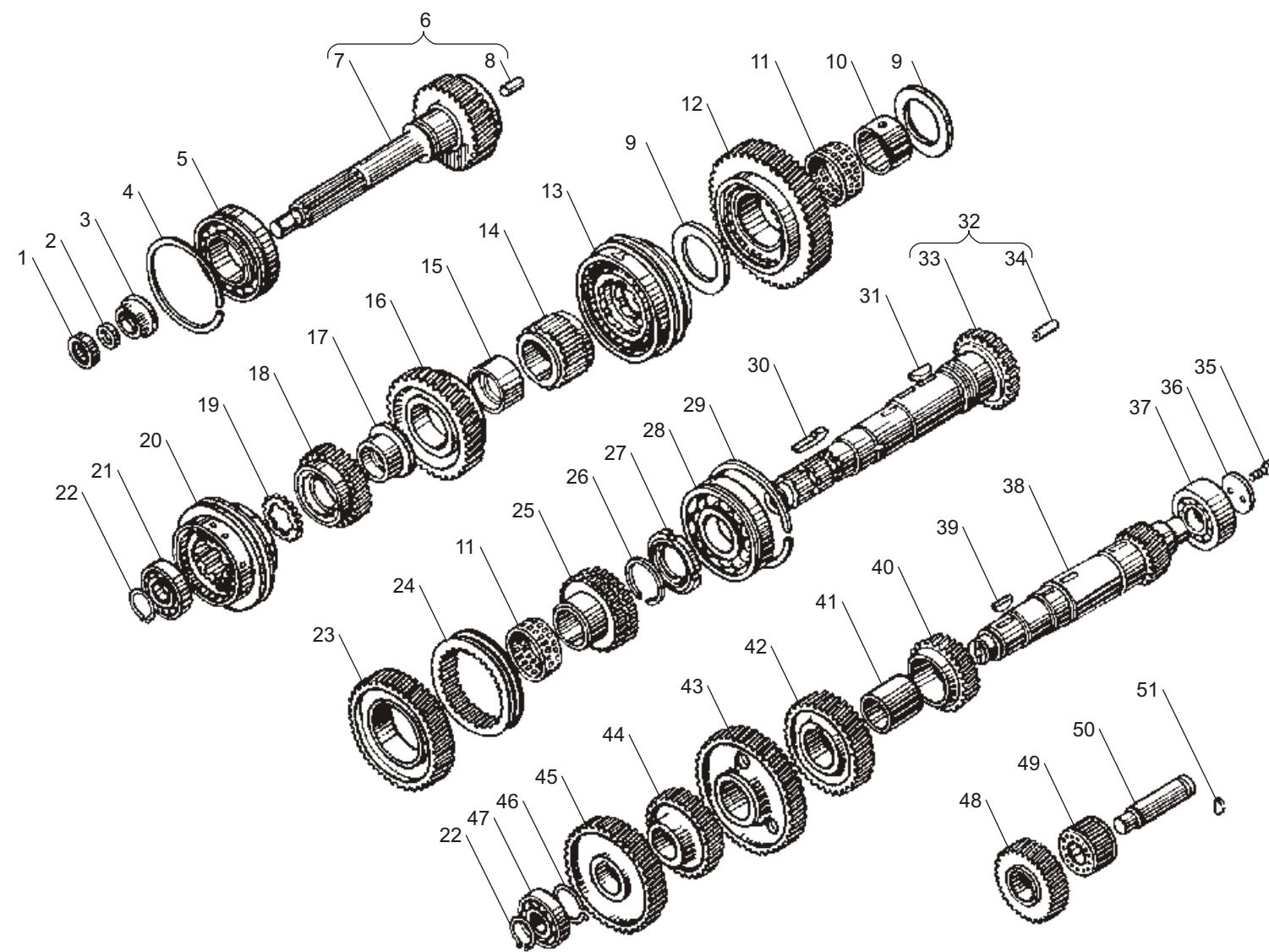
Рис. 5 ВАЛЫ И ШЕСТЕНИ КОРОБКИ ПЕРЕДАЧ ЯМЗ-2381 для двигателя ЯМЗ-6562.10
