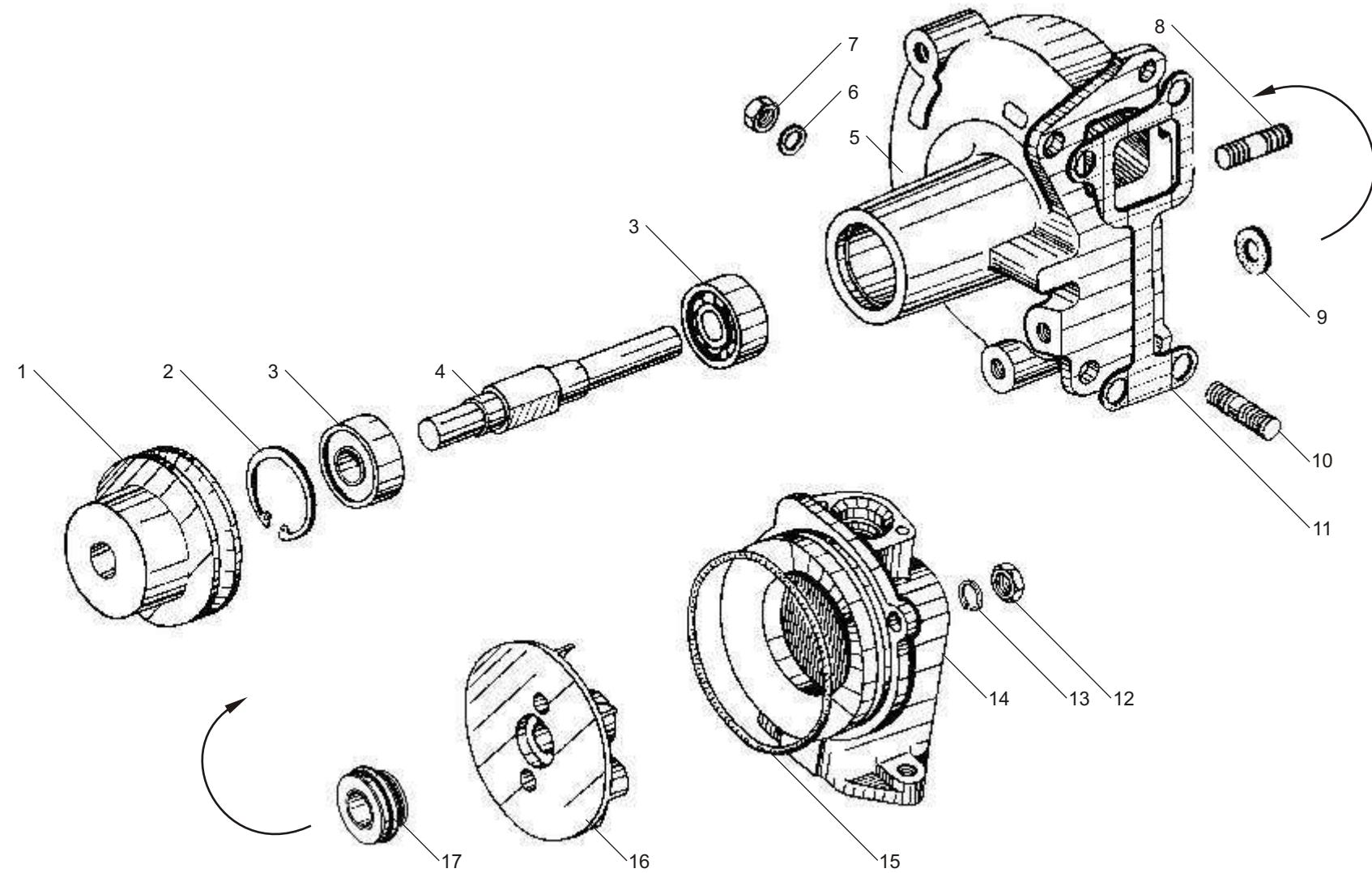
Рис. 29 ВОДЯНОЙ НАСОС двигателей ЯМЗ-6562.10, ЯМЗ-6563.10
