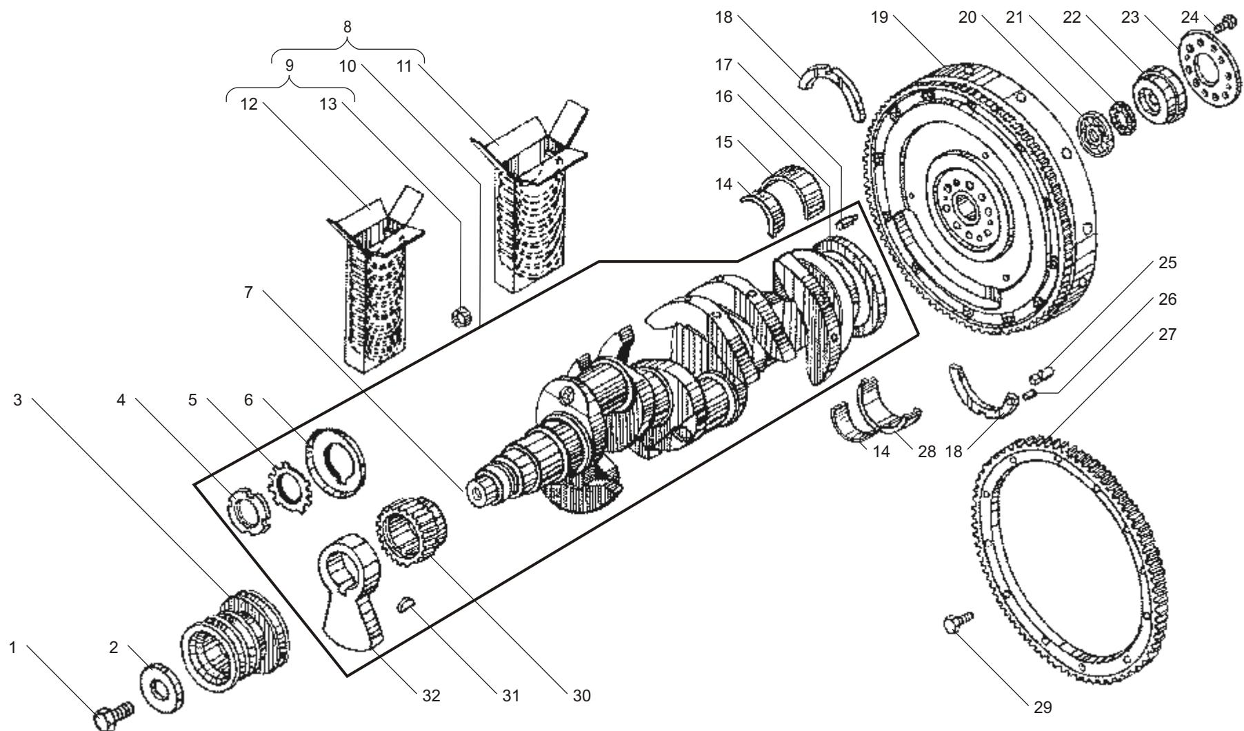
Рис. 6 ВАЛ КОЛЕНЧАТЫЙ И МАХОВИК двигателей ЯМЗ-6562.10, ЯМЗ-6563.10
