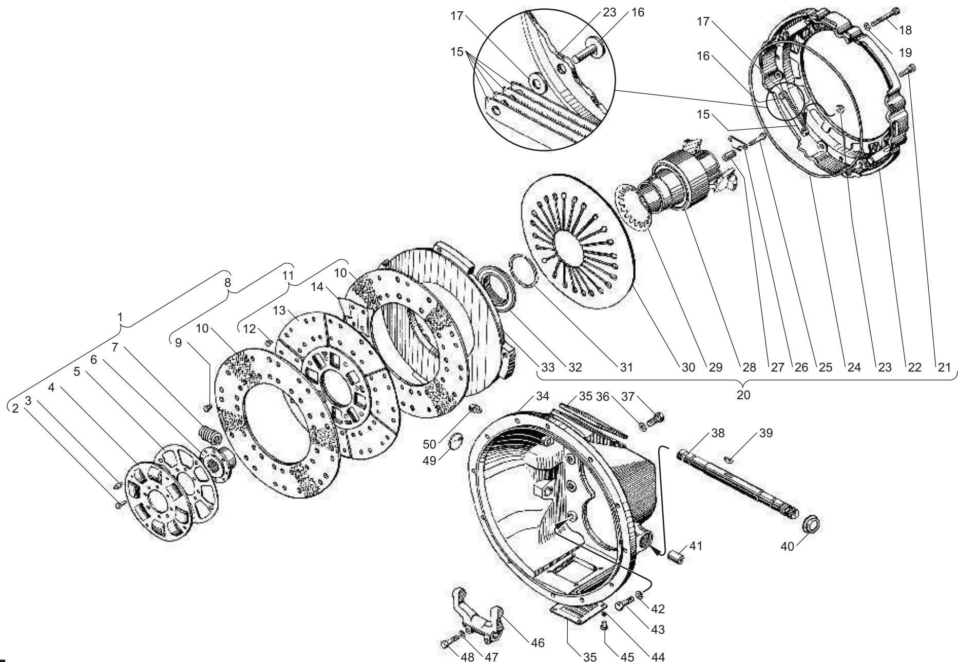
Рис. 1 СЦЕПЛЕНИЕ для двигателей ЯМЗ-6562.10, ЯМЗ-6563.10
