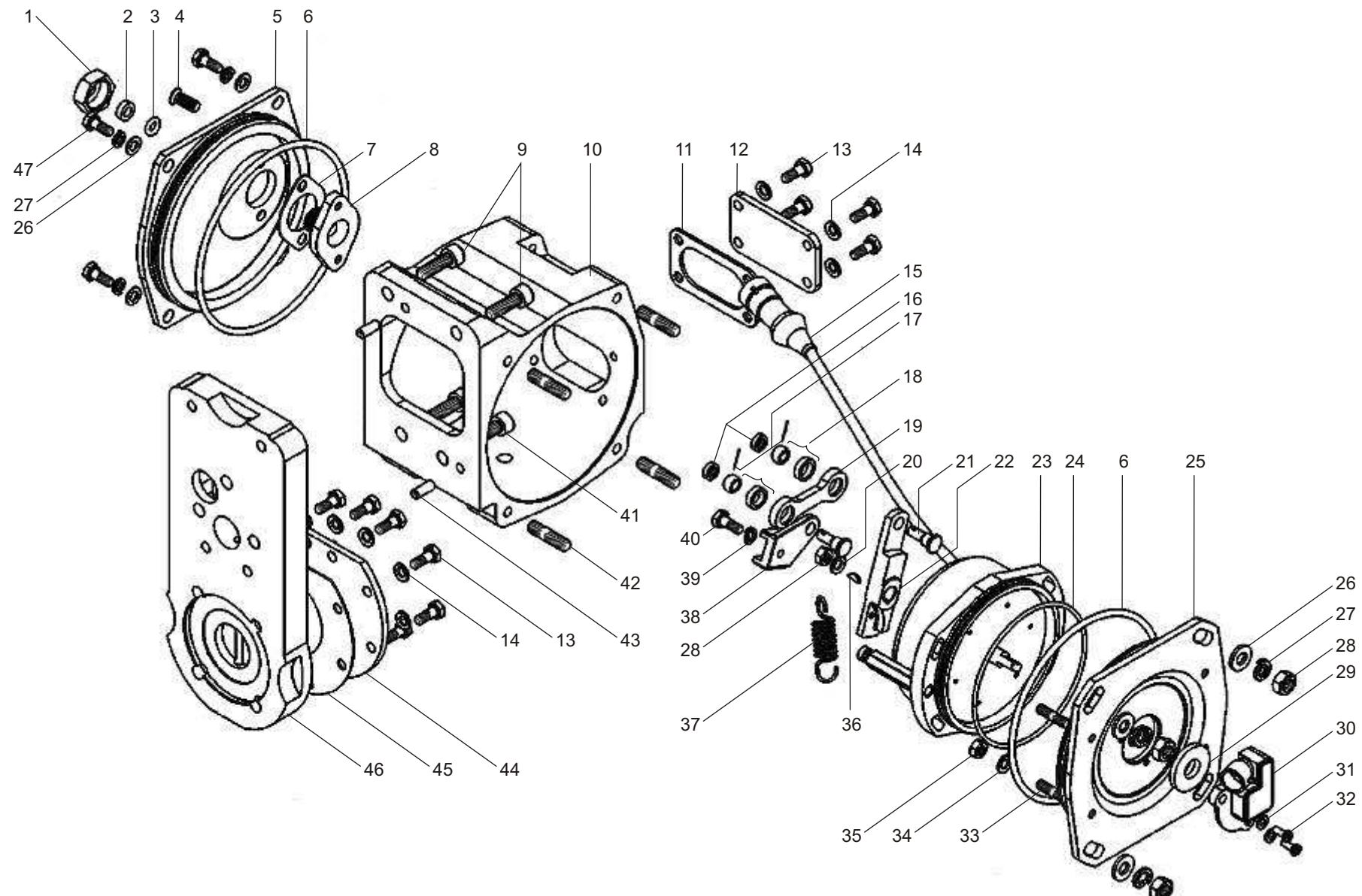
**Рис. 21 МЕХАНИЗМ ЭЛЕКТРОМЕХАНИЧЕСКИЙ ИСПОЛНИТЕЛЬНЫЙ (ЭИМ) двигателей ЯМЗ-6562.10, ЯМЗ-6563.10**
