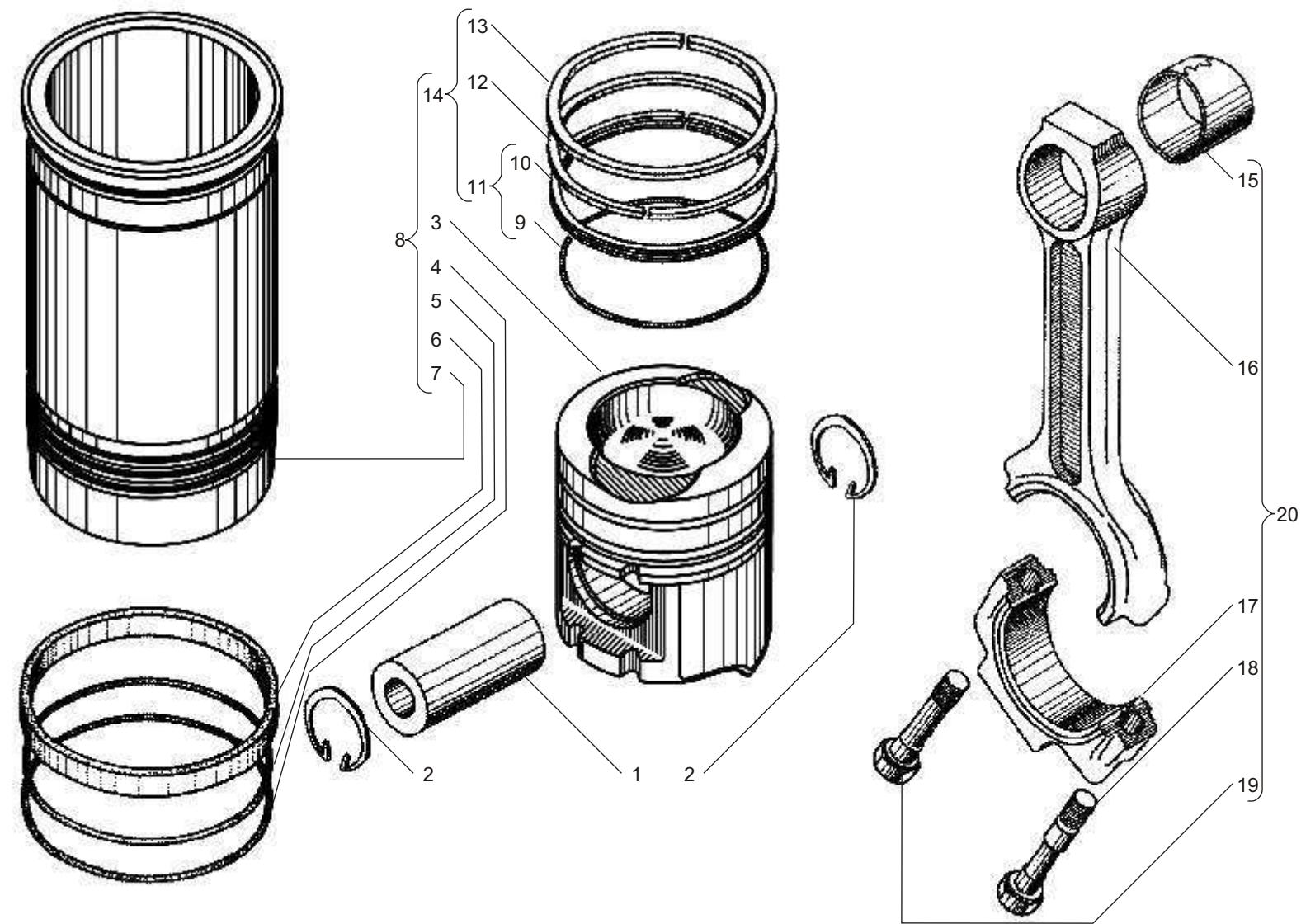
Рис. 5 ПОРШЕНЬ И ШАТУН двигателей ЯМЗ-6562.10, ЯМЗ-6563.10
