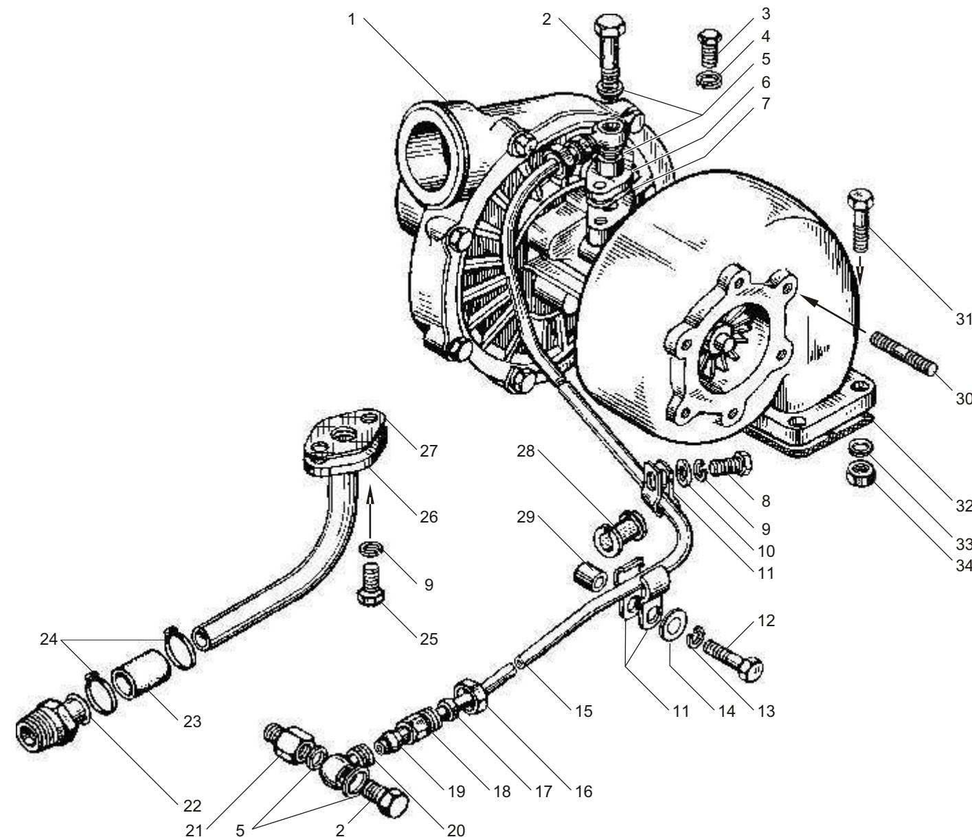
Рис. 27 ТРУБКИ ПОДВОДА И СЛИВА МАСЛА ТУРБОКОМПРЕССОРА двигателей ЯМЗ-6562.10, ЯМЗ-6563.10
