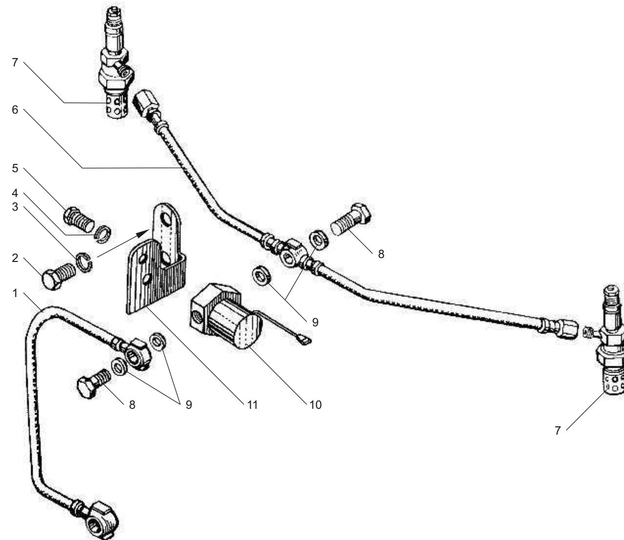
Рис. 16 ЭЛЕКТРОФАКЕЛЬНОЕ УСТРОЙСТВО двигателей ЯМЗ-6562.10, ЯМЗ-6563.10
