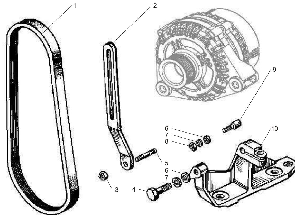
Рис. 35 УСТАНОВКА ГЕНЕРАТОРА двигателей ЯМЗ-6562.10, ЯМЗ-6563.10
