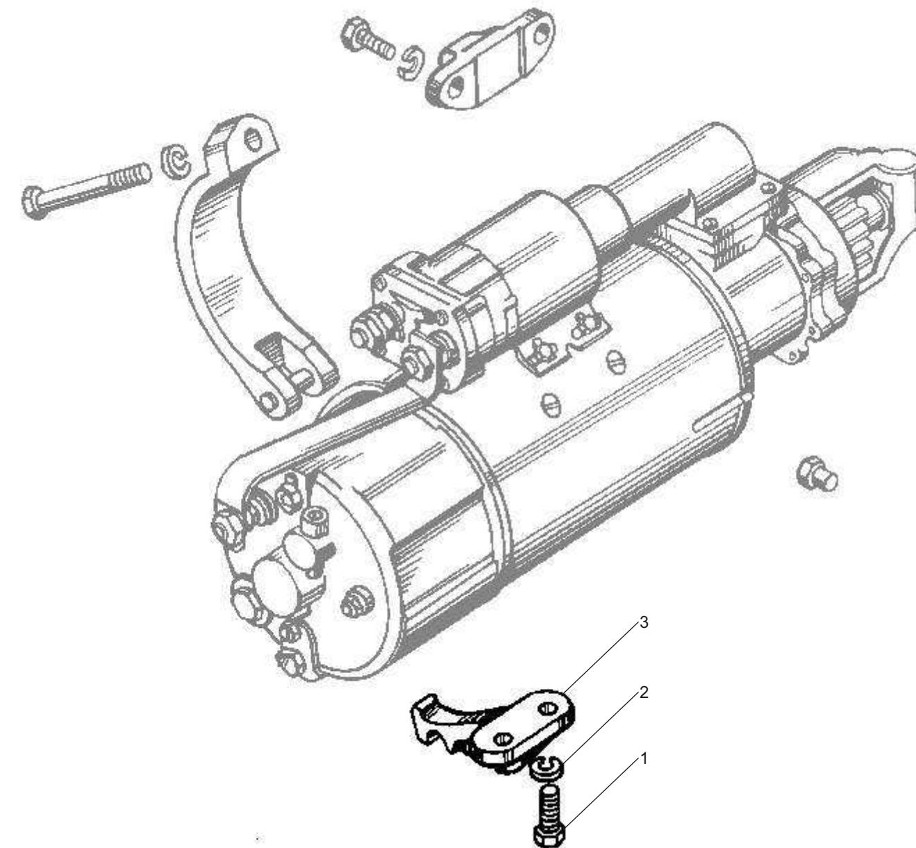
Рис. 36 УСТАНОВКА СТАРТЕРА двигателей ЯМЗ-6562.10, ЯМЗ-6563.10
