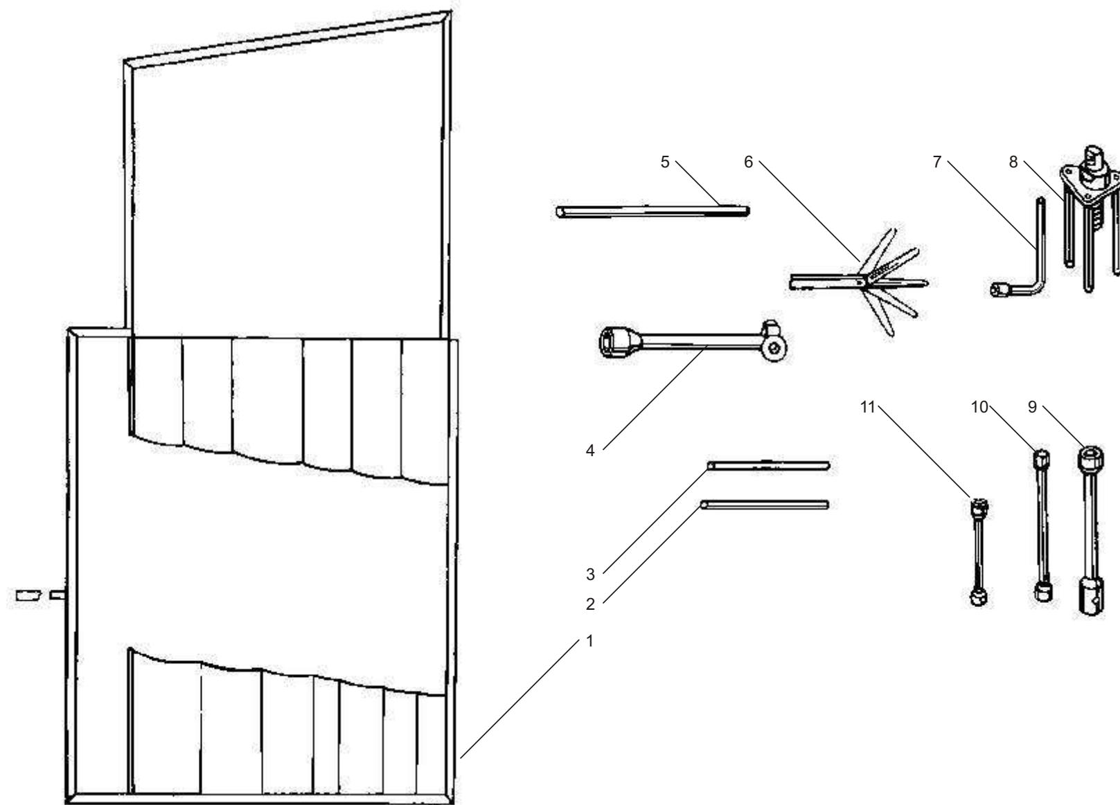
Рис. 38 ИНСТРУМЕНТ ВОДИТЕЛЯ И ПРИСПОСОБЛЕНИЯ двигателей ЯМЗ-6562.10, ЯМЗ-6563.10
