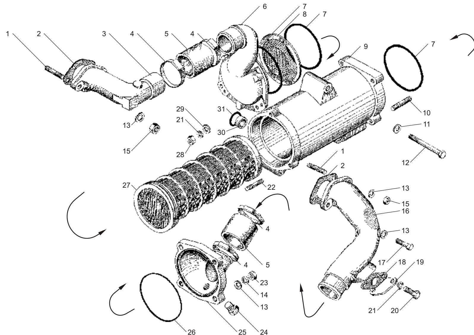
**Рис. 14 ТЕПЛООБМЕННИК ЖИДКОСТНО-МАСЛЯНЫЙ двигателей ЯМЗ-6562.10, ЯМЗ-6563.10**
