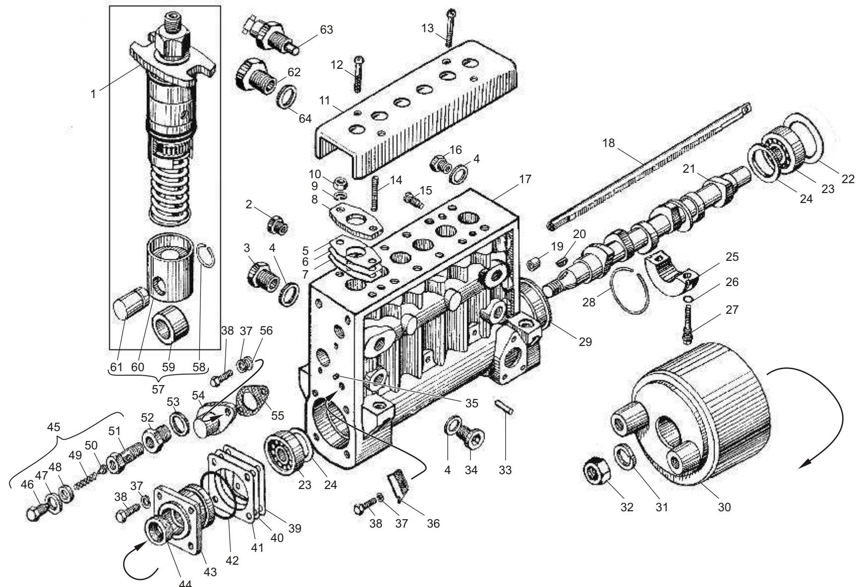
Рис. 22 ТОПЛИВНЫЙ НАСОС ВЫСОКОГО ДАВЛЕНИЯ двигателей ЯМЗ-6562.10, ЯМЗ-6563.10
