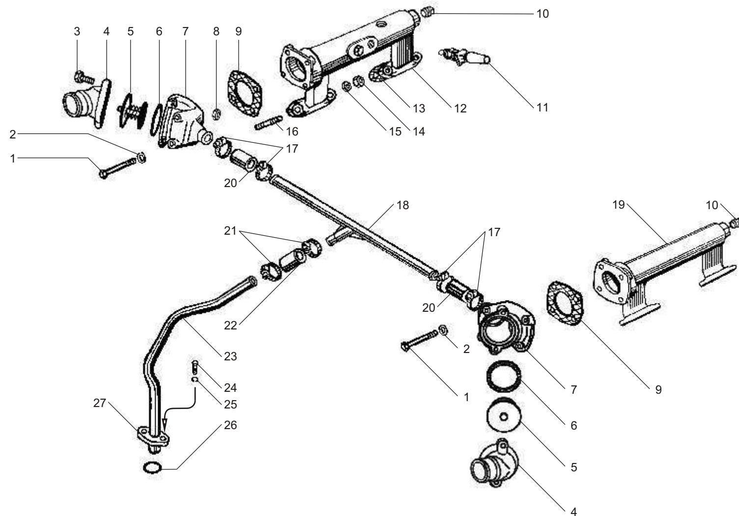
Рис. 28 ВОДЯНЫЕ ТРУБЫ И ТЕРМОСТАТЫ СИСТЕМЫ ОХЛАЖДЕНИЯ двигателей ЯМЗ-6562.10, ЯМЗ-6563.10
