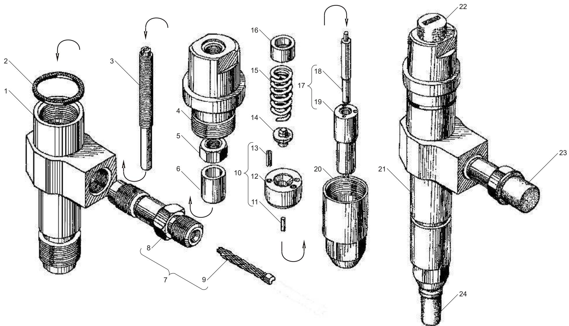
**Рис. 24** ФОРСУНКА двигателей ЯМЗ-6562.10, ЯМЗ-6563.10
