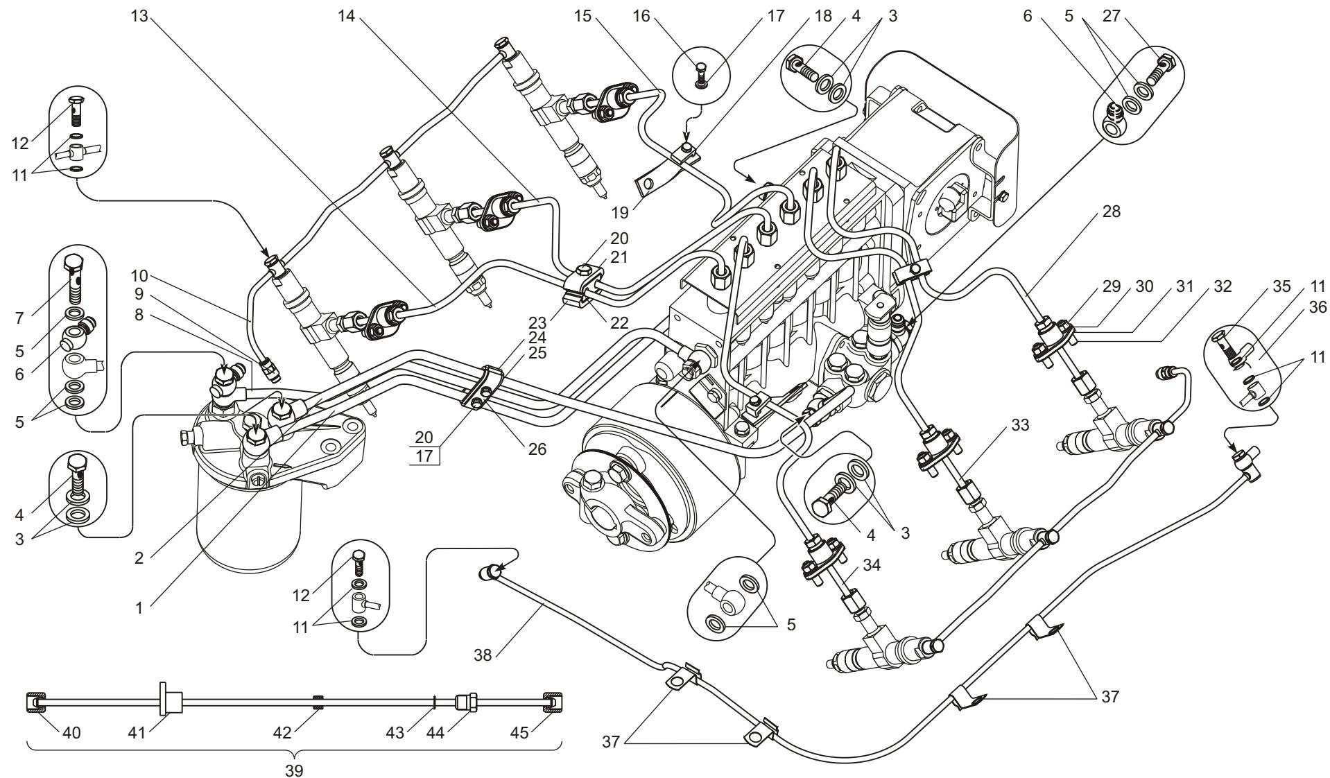
**Рис. 19 ТРУБОПРОВОДЫ ТОПЛИВНЫЕ двигателей ЯМЗ-6562.10, ЯМЗ-6563.10**
