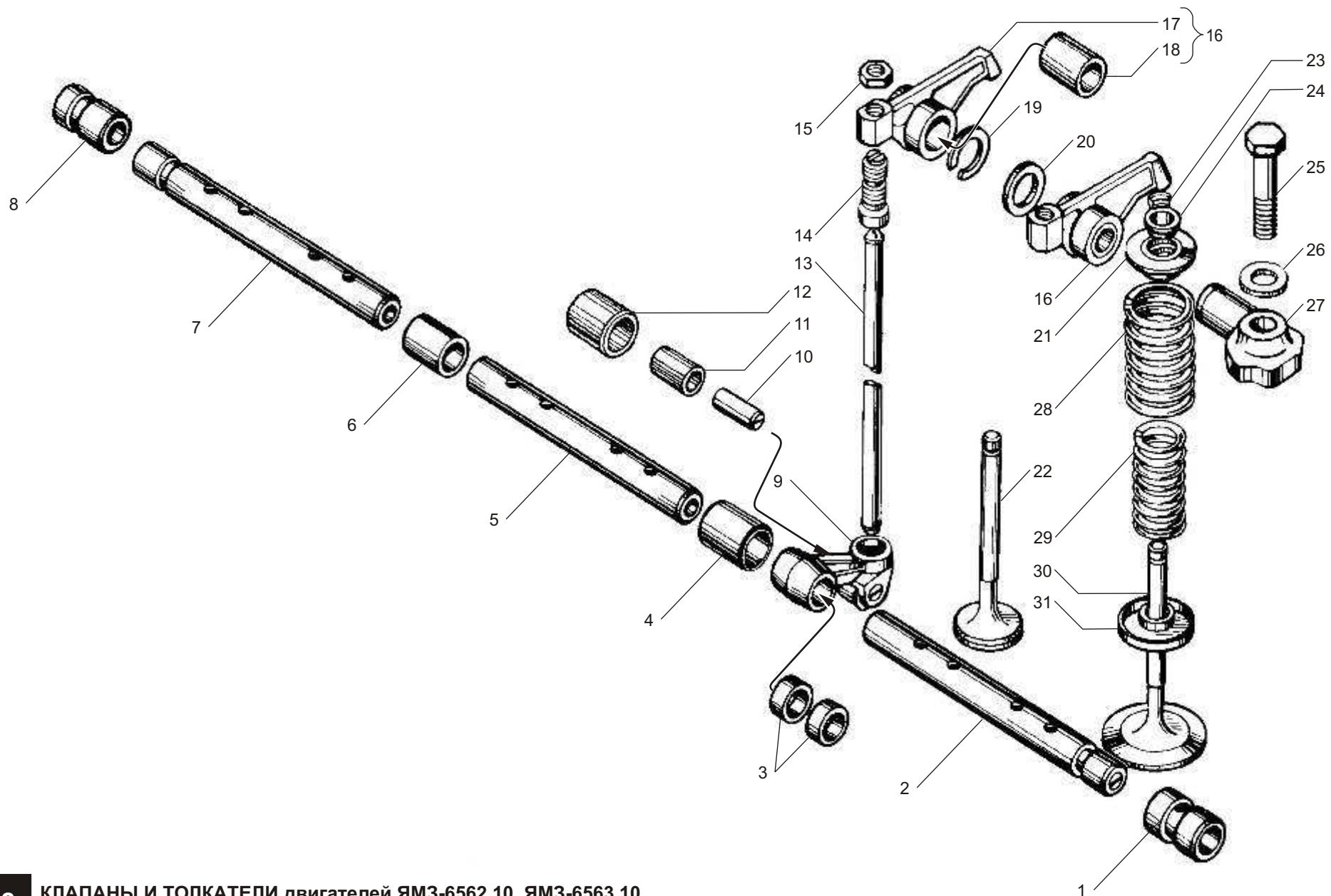
Рис. 8 КЛАПАНЫ И ТОЛКАТЕЛИ двигателей ЯМЗ-6562.10, ЯМЗ-6563.10
