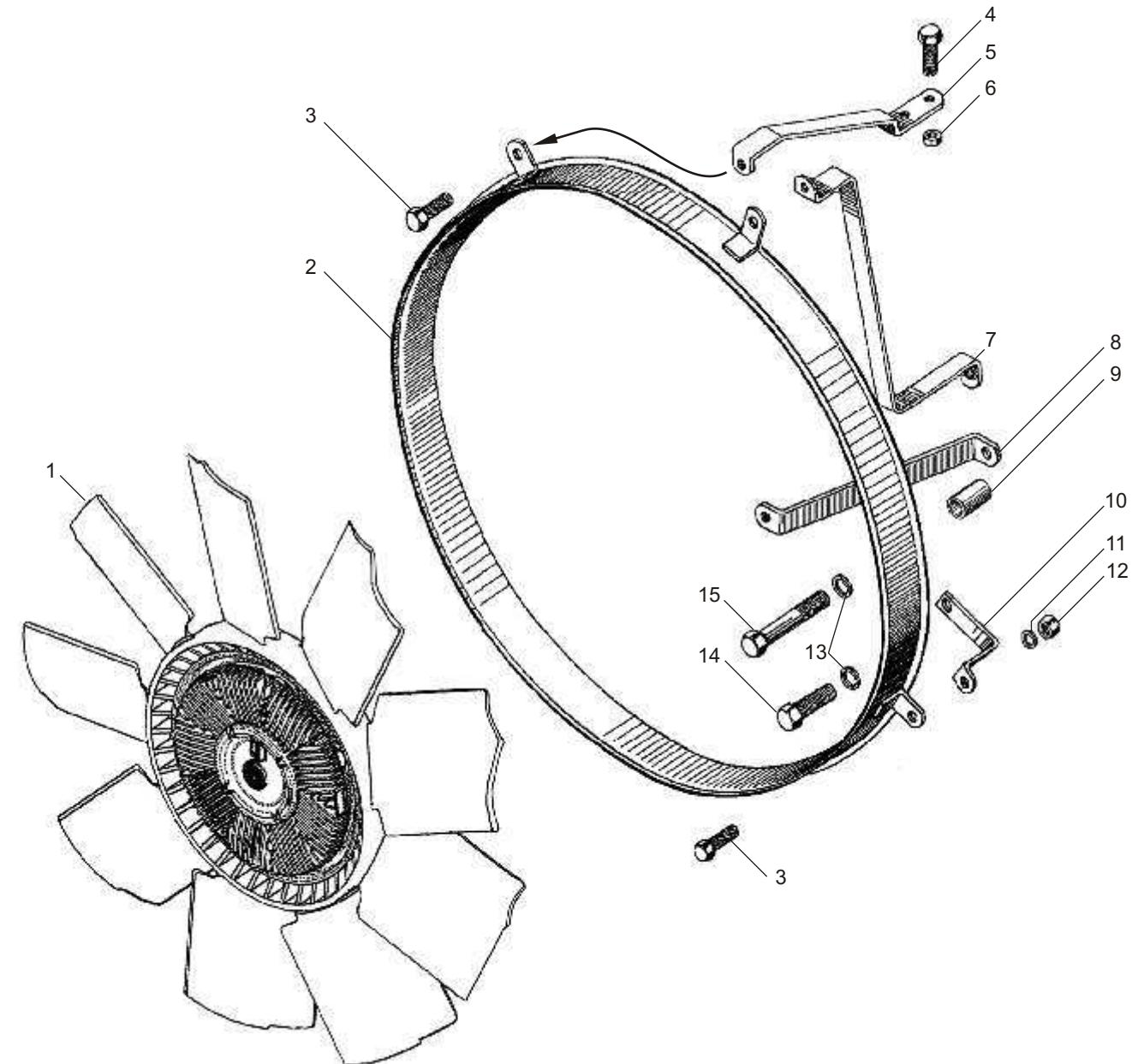
Рис. 31 ВЕНТИЛЯТОР И КОЖУХ ВЕНТИЛЯТОРА двигателей ЯМЗ-6562.10, ЯМЗ-6563.10
