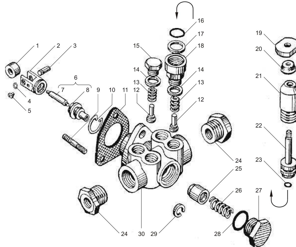
Рис. 20 НАСОС ТОПЛИВОПОДКАЧИВАЮЩИЙ двигателей ЯМЗ-6562.10, ЯМЗ-6563.10
